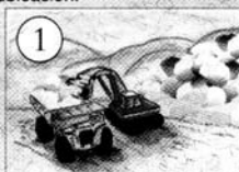
Se utilizarán excavadoras hidráulicas para cargar el hielo directamente en camiones.
